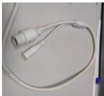
Рисунок Е.2 - Кабель подключения цифровой IP камеры с разъёмом питания (идёт в комплекте с блоками вызова с индексом IP)
